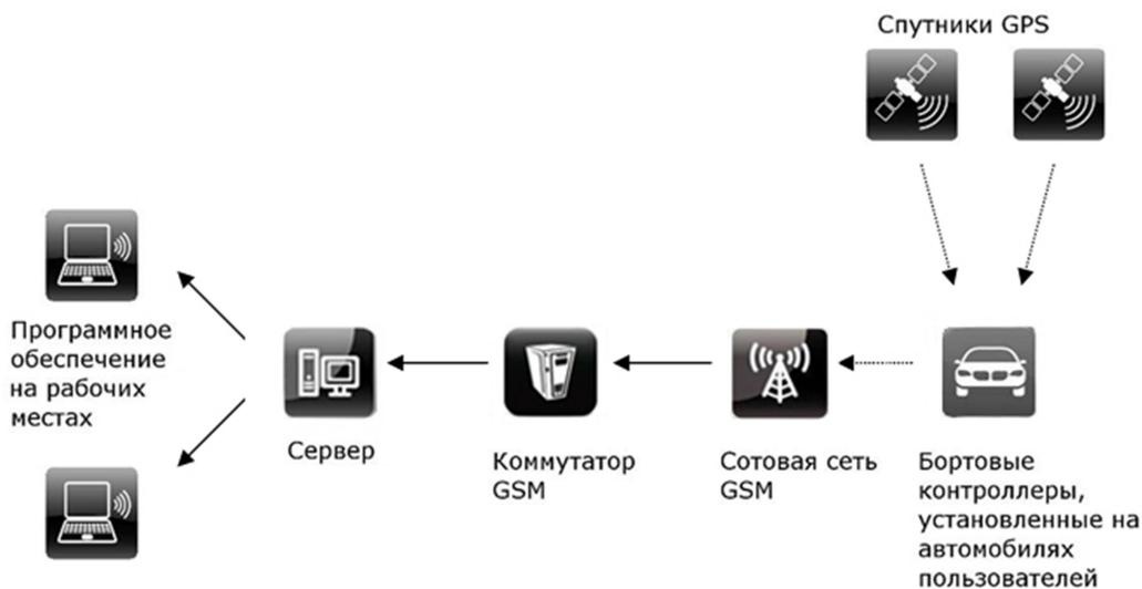
Рис. 1 Структура комплекса, включающего программу «Автосат-Мониторинг»
